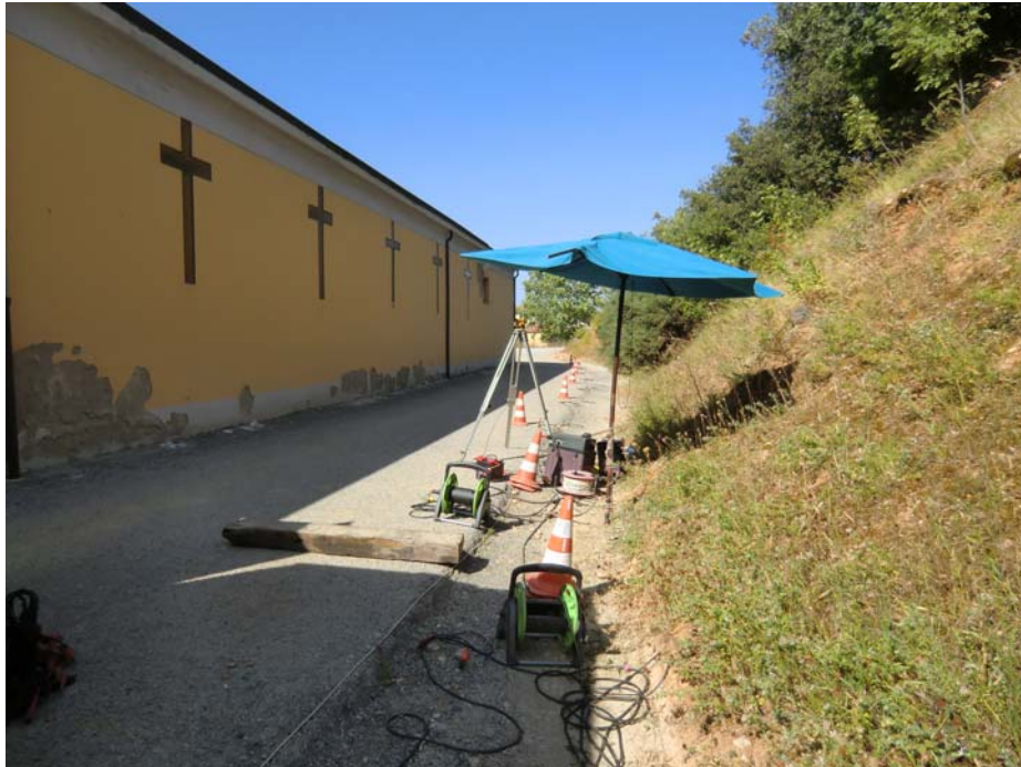
Profilo ST1 – Panoramica del sito indagato e stralcio dello stendimento di geofoni da 10Hz con interdistanza 4m.
