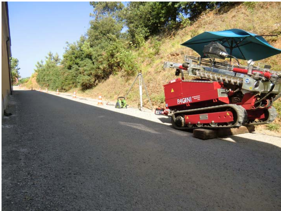
Profilo ST1 – Stralcio dello stendimento di sismica a rifrazione e sistema utilizzato per la generazione delle onde sismiche di taglio (traversina di legno con sovraccarico percossa da un pendolo alle estremità).
